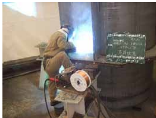
図 - 6 レグトップの実製作状況
