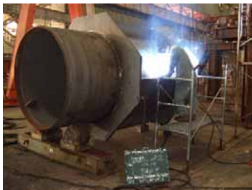
図 - 6 レグトップの実製作状況
